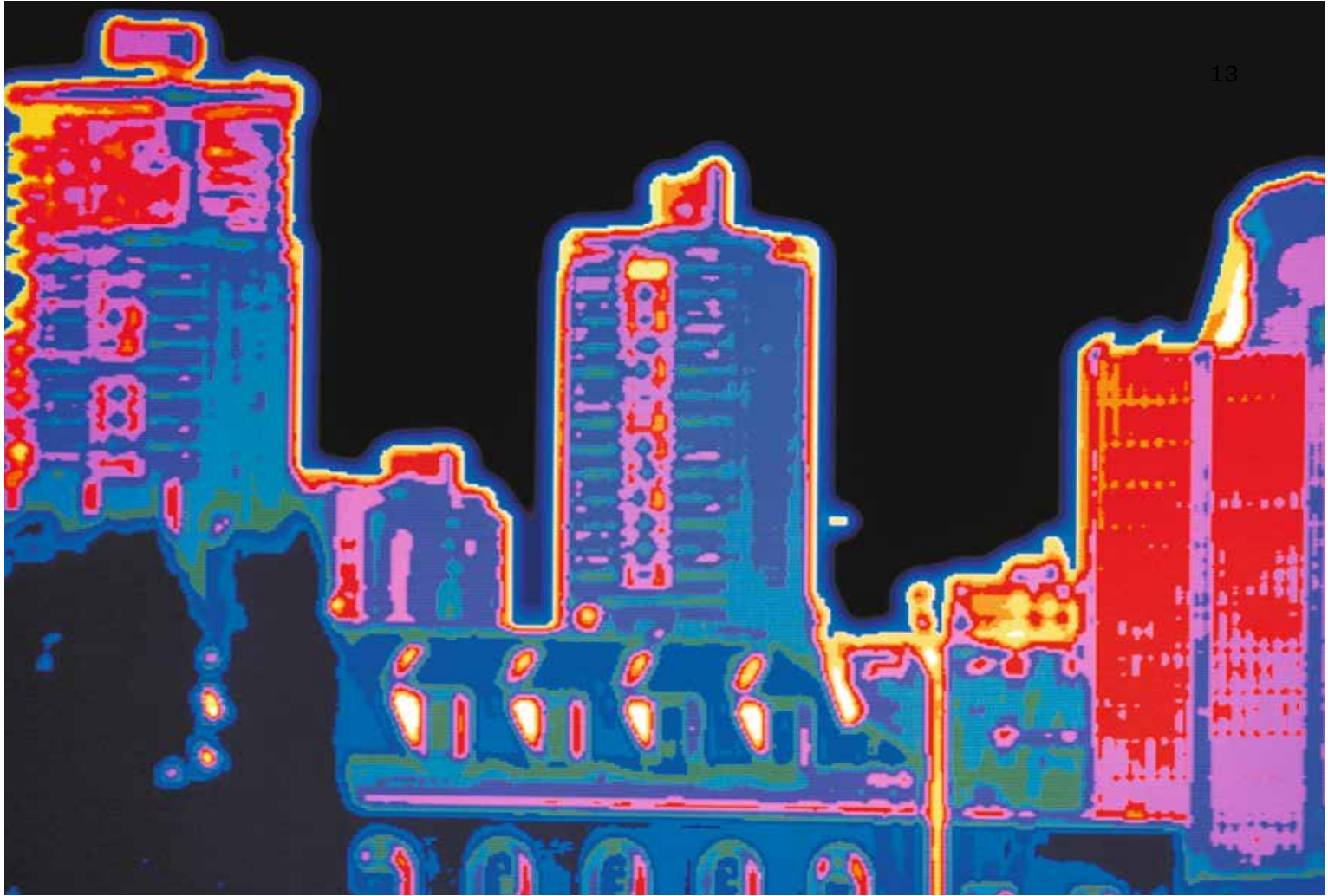
Glasfassaden sind Energiefresser: Am meisten Wärme entweicht über Fensterflächen.
