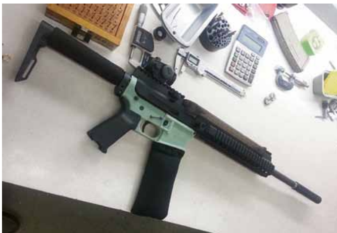
Die Abzugsautomatik dieses Sturmgewehrs vom Typ AR-15 wurde mit einem 3D-Printer gedruckt. Der Kunststoff hielt gerade mal sechs Schüssen stand.
